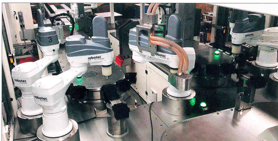
Anlage zur Prüfung, Bestückung und Verpackung von in 96er-Trays aufgereihten Pipetten für die Labordiagnostik. (Bilder: Robotec)
